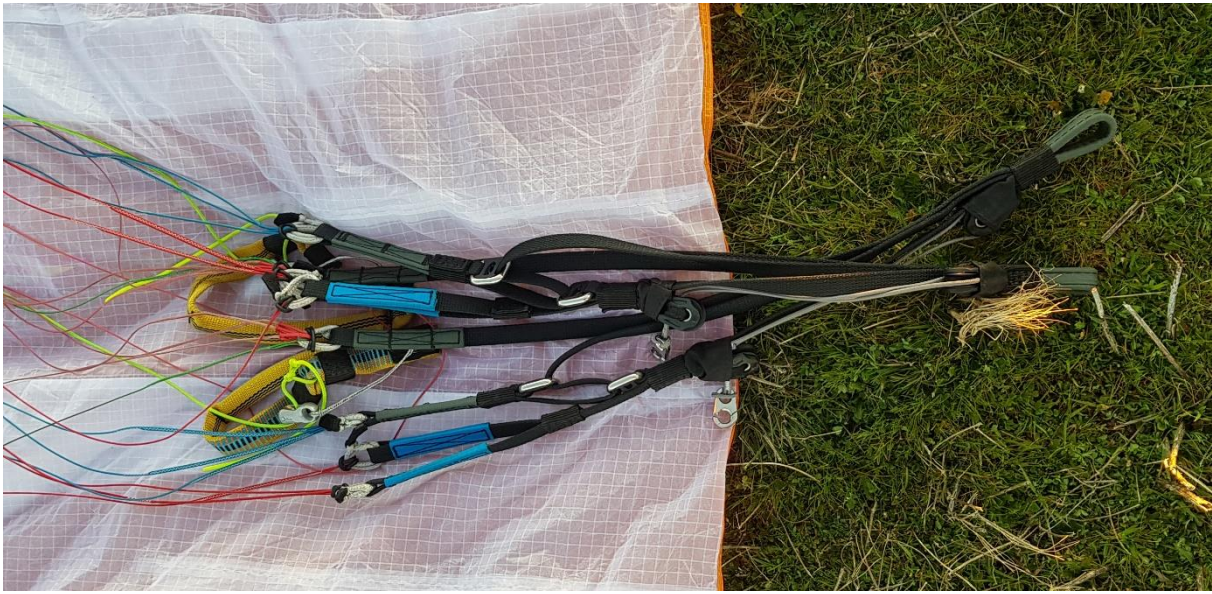
Altbekannter Ozone Tragegurt – C-Ebene ohne C-Handle-Schlaufen – Dyneema-Locks
