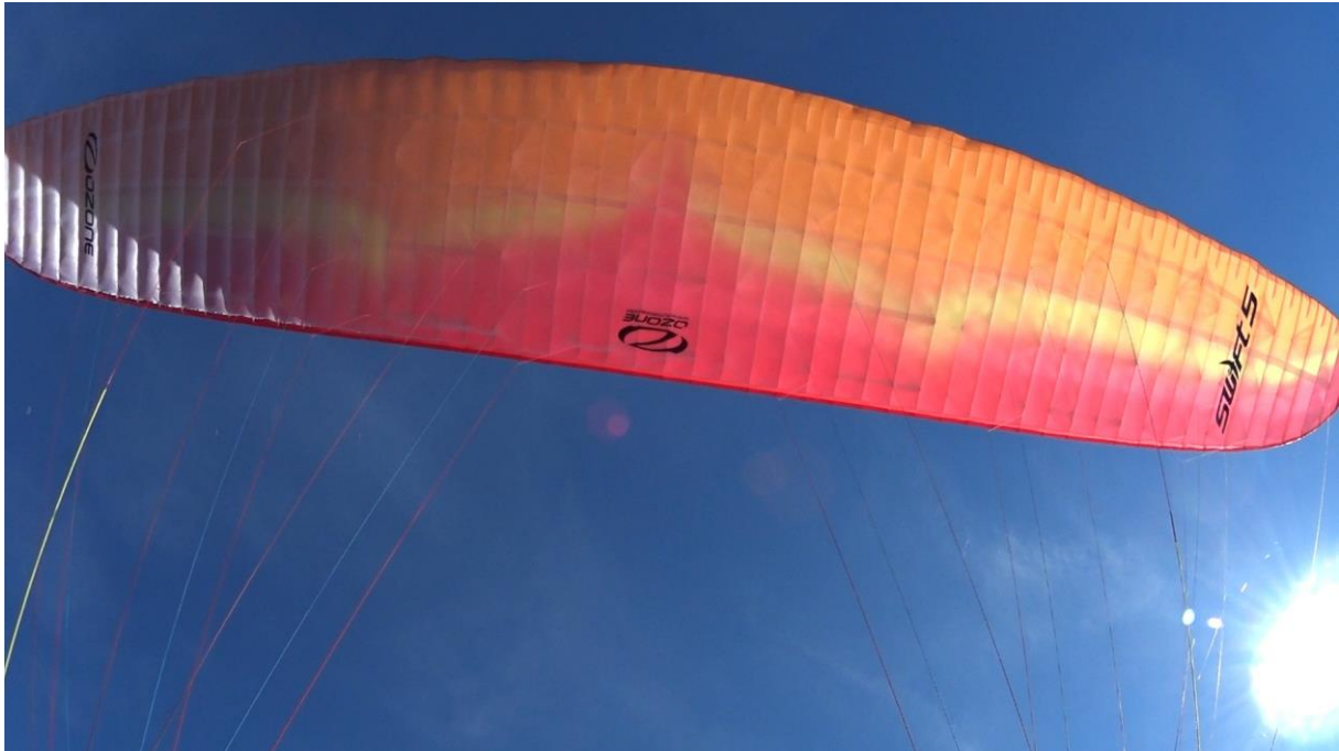
Ozone-Swift 5 / 4,1 kg Schirmgewicht / Leichtsegel mit ideal austarierter Gewichtsverteilung im Segel/ markant leichte Eintrittskante
